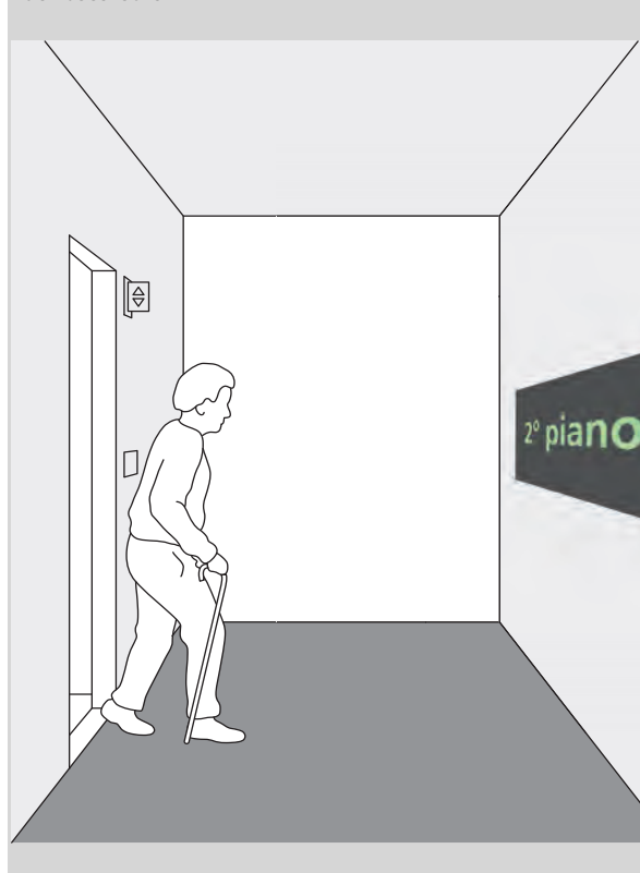
Figura 38 Indicazioni dei piani ben visibili, di fronte all'uscita dell'ascensore
