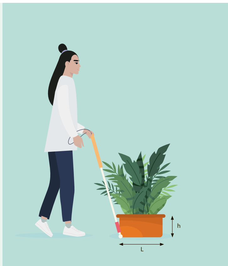
Figura 8: dimensioni minime degli ostacoli a terra fino a 1,0 m di altezza (a sinistra). Se rispettano le dimensioni minime, tali ostacoli sono facilmente riconoscibili e identificabili al tatto da persone ipovedenti (a destra; basato su [3,45]).
