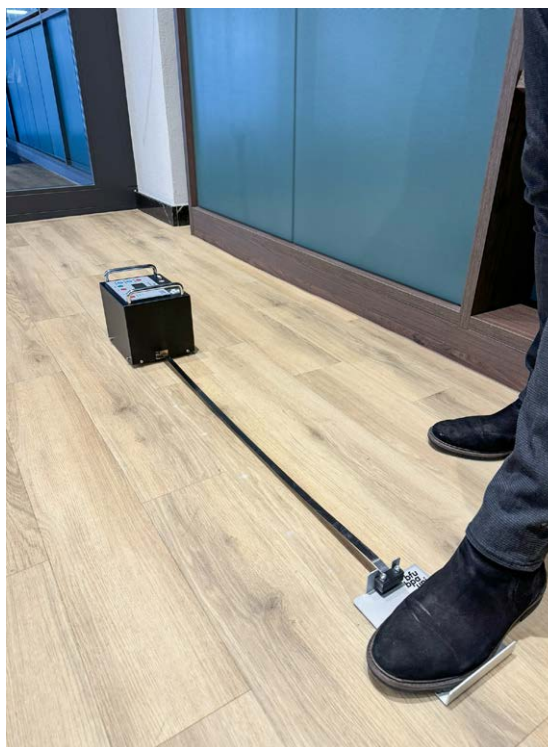
Figura 2: determinazione della resistenza allo scivolamento con il metodo della prova su piano inclinato (a sinistra; foto: Orhan Ceylan, Institut für Arbeitsschutz, DGV) e con il tribometro (a destra; foto: UPI)
